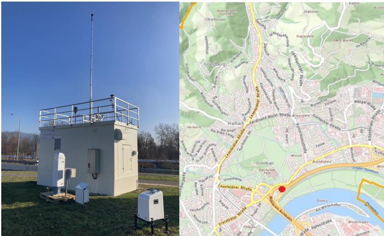
Abbildung 2-1: Standort bei der Luftgütemessstelle 24er Turm in Linz. Links: Foto der Messstation mit Ceilometer (links vor dem Messkontainer) und Windlidar (rechts), rechts: Landkarte mit Messstandort (roter Punkt). Bildquelle: DORIS, BEV
